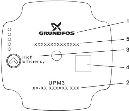
Fig. 5 Nameplate: Grundfos standard
